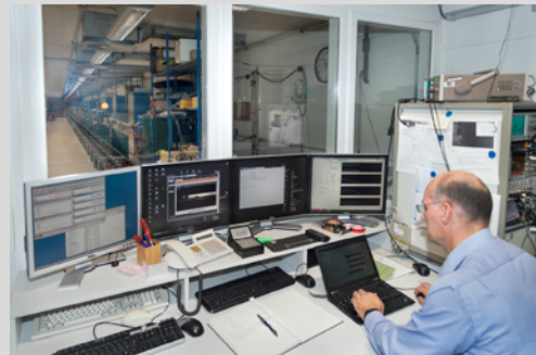
PTB-Labor „Geodätische Basis“ mit laserinterferometrischen Messungen
