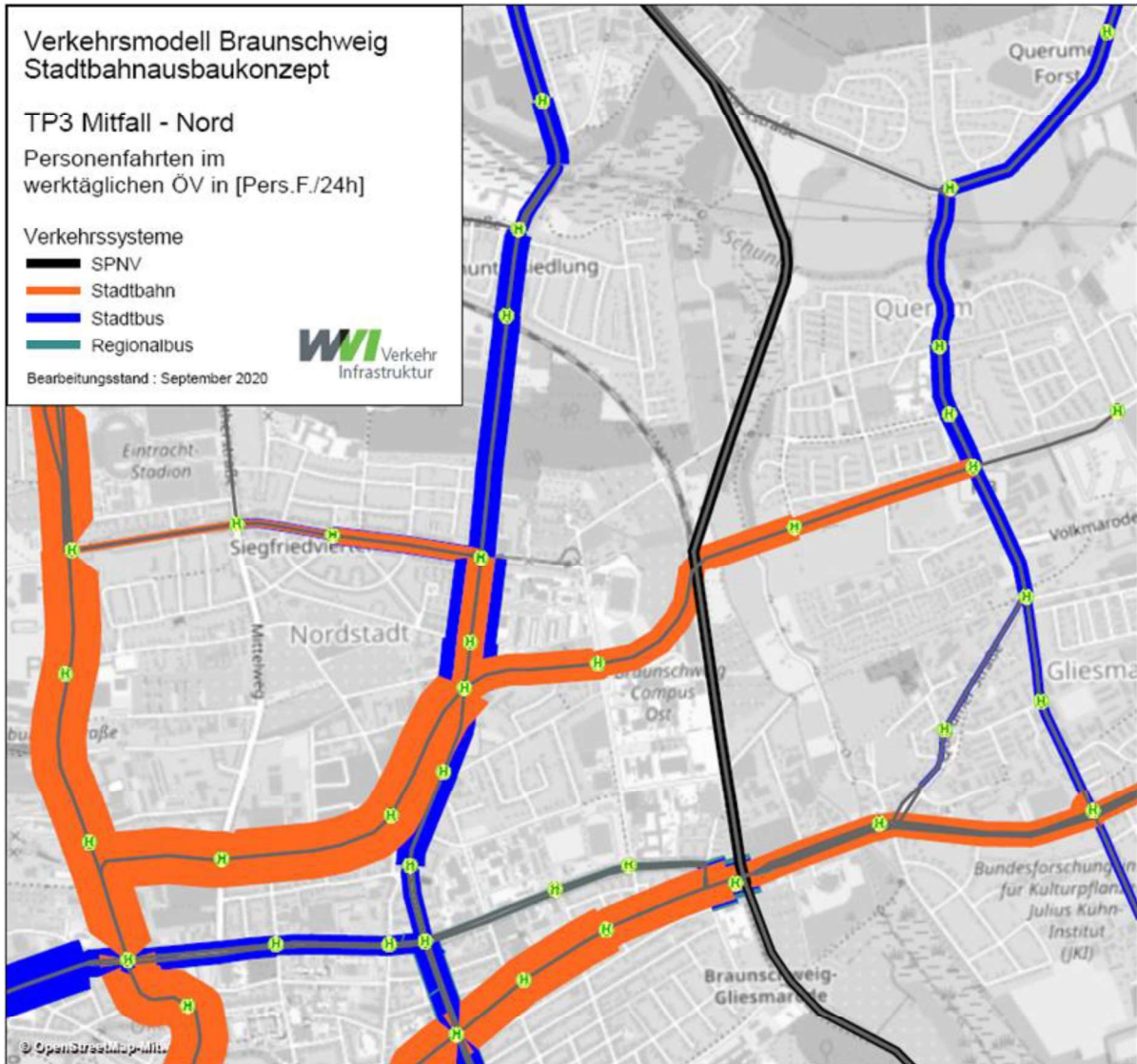
Abbildung 6-10: Teilprojekt Heidberg/Salzdahlumer Straße - Campusbahn/Querum, Verkehrsbelastung ÖV im Mitfall im nördlichen Projektteil (Planungsstand 09/2020)
